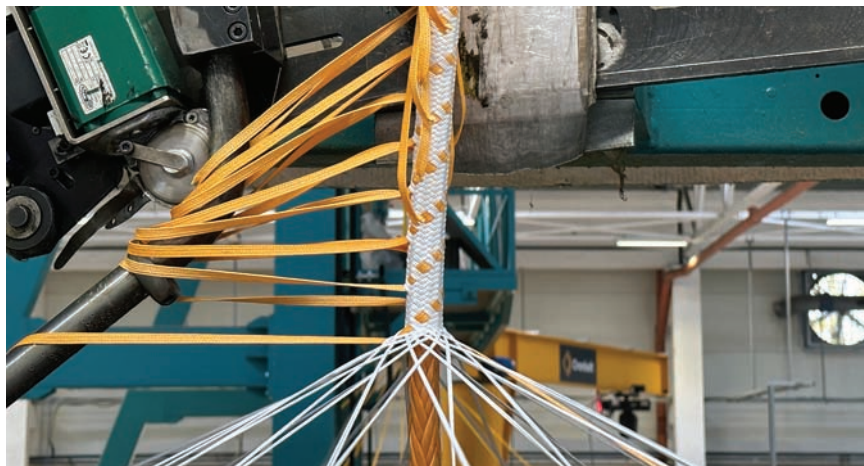
Yfirflétting á Dynlce ofurtógi fyrir seismísk skip, en slík skip skanna jarðlög hafsbotnsins.
