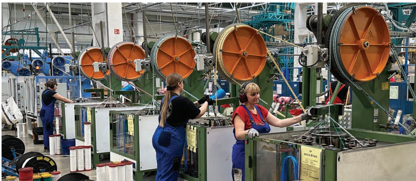
Flétting á möskvaleggjum í Glóriu flottroll í Hampidjan Baltic en þar er búið að auka afkastagetuna í 7.000 leggi á viku sem er sá fjöldi sem þarf í 2-3 flottroll, allt eftir stærð þeirra.
